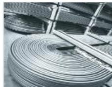
U-Rohre für Wärmetauscher
